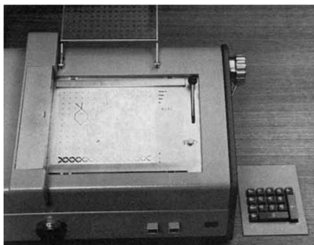
Abb. 2. Formellesemaschine. Die Struktur wird auf ein transparentes Rasterblatt gezeichnet, das in einen Schlitten eingelegt und von zwölf Photozellen abgetastet wird; dabei entsteht ein Lochstreifen, der auf dem Computer weiterverarbeitet wird.
